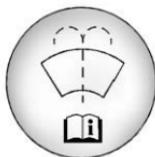
Abra el tapón que tiene el símbolo del lavaparabrisas. Añada líquido de lavado hasta llenar el depósito. Vea en *Vista general del compartimiento del motor* ⇨ 259 la ubicación del depósito.
