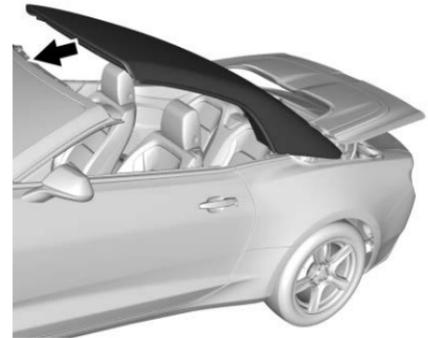
2. Levante y mueva el toldo convertible hacia adelante jalándolo de ambos lados del arco delantero hacia la posición totalmente cerrada.
