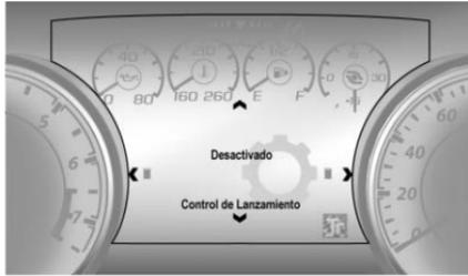
Asegúrese de que el freno de estacionamiento no esté activado para volver a ingresar Control de Lanzamiento.
