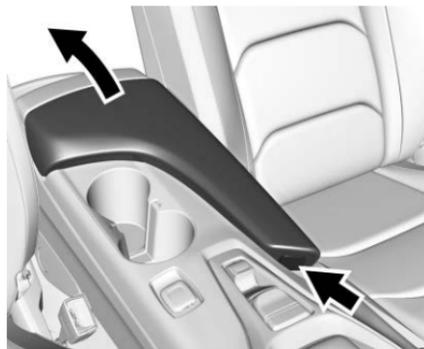
Presione para abrir. Hay dos puertos USB y un conector auxiliar en el interior. Vea el manual de infoentretenimiento.
