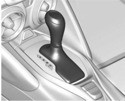
**P** : Esta posición bloquea las ruedas motrices. Utilice P (estacionamiento) al arrancar el motor, ya que el vehículo no puede moverse con facilidad.
