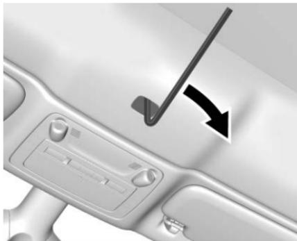
3. Bloquee el frente del toldo convertible al bastidor soltando la cubierta pequeña, insertando una llave hexagonal, y girándola en el sentido de las manecillas del reloj hasta que se detenga.
