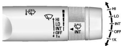
La palanca del limpiaparabrisas/lavador está en el lado derecho de la columna de dirección. Con la ignición encendida o en ACC/ACCESSORY (accesorios), mueva
