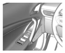
Presione el interruptor a para desactivar el interruptor de las ventanas eléctricas de la puerta trasera. Para activar, presione unevamente.
