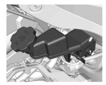
El nivel del líquido de frenos debe estar entre las marcas **MIN** y **MAX**.
