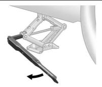
Levante el vehículo, haciendo girar la manija del gato en el sentido de las manecillas del reloj. Eleve el vehículo a una altura tal, de manera que haya espacio suficiente para que la llanta usada no toque el suelo.
