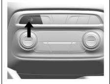
La luz indicadora, integrada en el interruptor de seguros eléctricos de la puerta, indica el estado del sistema.
