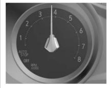
El tacómetro muestra le velocidad del motor en revoluciones por minuto (rpm).
