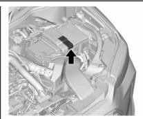
Terminal de batería positiva (+) remota (debajo de la cubierta)
