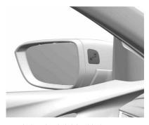
Cuando la velocidad del vehículo es mayor a 10km/h, se activará el sistema de alarma de punto ciego lateral. Cuando la velocidad del vehículo es demasiado alta, el sistema se apagará, y la luz indicadora I de los espejos exteriores izquierdo y derecho se atenuará; en este momento, si se reduce la velocidad del vehículo, se apagará la luz indicadora del espejo. Si un vehículo se detecta en el punto ciego en este momento, la luz indicadora I del espejo retrovisor correspondiente se iluminará.
