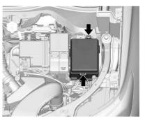
La caja de fusibles se ubica en la parte frontal izquierda del compartimiento del motor.
