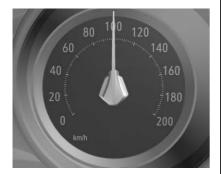
El velocímetro muestra la velocidad del vehículo en kilómetros por hora (km/h).
