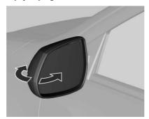
Para seguridad de los peatones, los espejos exteriores se giran fuera de su posición normal de montaje si se golpean con suficiente fuerza. Vuelva a colocar el espejo aplicando una ligera presión a la carcasa del espejo. Esta función también es útil para reducir el ancho total del vehículo para prevenir daños cuando el vehículo esté estacionado. Empuje el espejo hacia atrás en la posición de funcionamiento antes de conducir.
