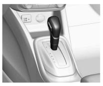
P: Esta posición bloquea las ruedas motrices. Utilice P (estacionamiento) al arrancar el motor, ya que el vehículo no puede moverse con facilidad.
