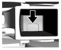
Coloque la llave electrónica en el almacenamiento de la consola central.
