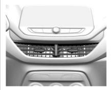
Use las persianas en las ventilas de aire para cambiar la dirección del flujo del aire.
