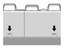
No sujete nada además de un sistema de asiento de seguridad para niños a los anclajes de atadura superior del vehículo. Instrucciones para sujetar el asiento de seguridad para niños al anclaje de atadura superior:
