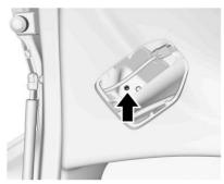
3. Retire el tornillo que sujeta el ensamble de la luz trasera a la puerta trasera.
