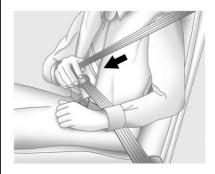
Sujete la placa de cerrojo y jale el cinturón frente a usted. No permita que se tuerza. El cinturón de regazo-hombro se puede bloquear si jala el cinturón a través de usted demasiado rápido. Si esto sucede, permita que el cinturón retroceda ligeramente para desbloquearlo. Después jale el cinturón frente a usted con más lentitud.
