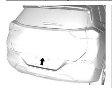
Para abrir la puerta trasera, presione en el interruptor de bloqueo de puerta eléctrica o presione en el transmisor RKE dos veces para abrir todas las puertas. Oprima la almohadilla táctil en el lado inferior de la manija de la puerta trasera y levántela.
