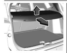
Para retirar la cubierta del vehículo, desamarre la cuerda y retire la cubierta de la ranura. Para volver a instalar, coloque cada extremo de la cubierta en las ranuras y amarre la cuerda en la puerta trasera.
