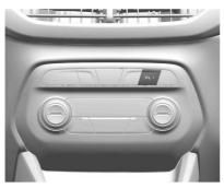
El botón P™ se usa para encender o apagar la Asistencia de estacionamiento delantero o trasero y la Alerta de tráfico trasero cruzado al mismo tiempo. La luz indicadora al lado del botón se enciende cuando las funciones no están encendidas y se apaga cuando se han deshabilitado.
