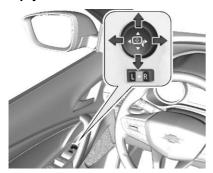
El control para los espejos eléctricos se encuentra en la moldura de la puerta a un lado del conductor.
