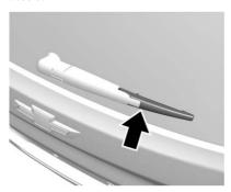
Levante el brazo del limpiador. Empuje la pluma en ángulo sobre el brazo del limpiaparabrisas, hacia abajo hasta que se libere.
