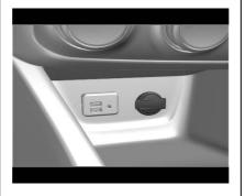
Las tomas de corriente para accesorios se pueden utilizar para conectar equipos eléctricos, como teléfonos celulares, o reproductores de MP3.
