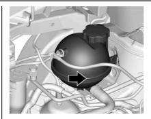
El tanque de compensación del refrigerante se encuentra en el compartimiento del motor, en el lado del pasajero del vehículo. Vea Vista general del compartimiento del motor
