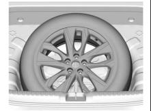
Instale la llanta ponchada en la cajuela. Primero, empuje el extremo trasero de la llanta ponchada contra el piso trasero. Después empuje el extremo delantero de la llanta ponchada contra el piso trasero.
